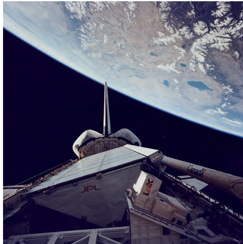
▼ Антенна радара в отсеке полезной нагрузки шаттла Endeavour. Миссия STS-59, 1994 г.
